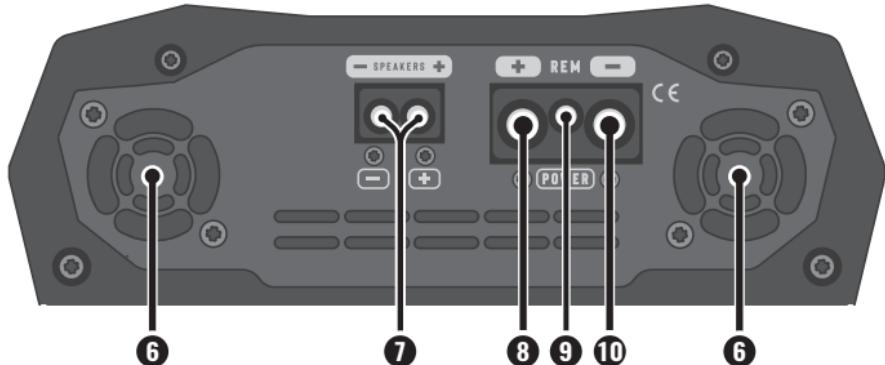
**6. COOLER:** Proporciona enfriamiento para el amplificador. Realice la instalación en un lugar ventilado, sin obstruir las entradas y salidas de aire.
