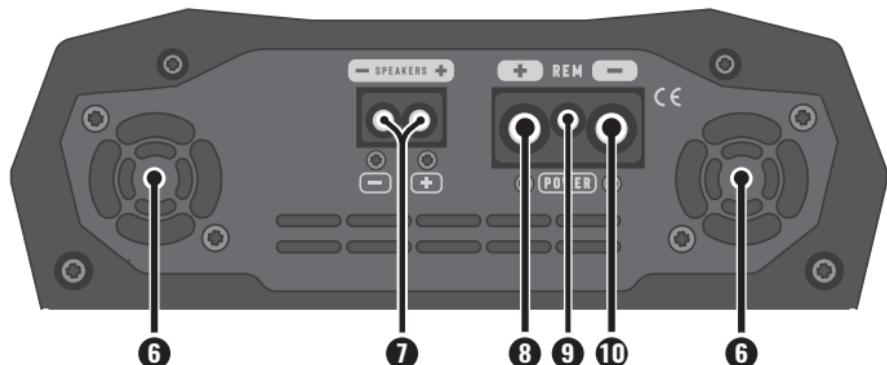
**6. COOLER:** Fornisce il raffreddamento per l'amplificatore. Effettuare l'installazione in un luogo ventilato, senza ostruire le prese d'aria e le uscite.
