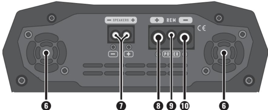
**6. COOLER:** Ele proporciona o resfriamento do amplificador. Faça a instalação em local arejado, sem obstrução das entradas e saídas de ar.
