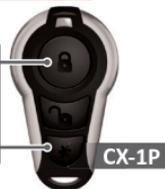
**⚠** Após o uso, é recomendado desativar a transmissão periódica para prolongar a vida útil da bateria **CR2032 3V (Recomenda-se fazer a substituição da bateria a cada 4 meses)**. O alarme emitirá 1 bip ao ligar a ignição caso a bateria do controle esteja fraca.
